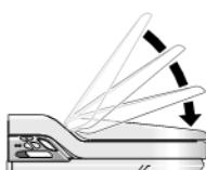
Амортизаторы обеспечивают бесшумное опускание и плавное закрывание сиденья и крышки унитаза. Открывание сиденья и крышки выполняется так же, как и в обычном унитазе.
